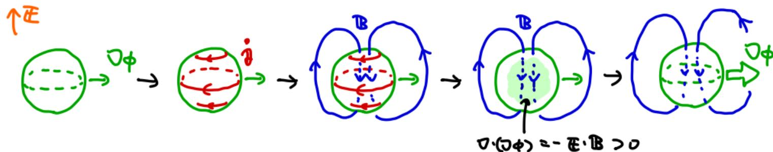
一様電場中で  $\nabla\phi$  と  $B$  が増幅する不安定性が生じる ( $\nabla\phi$  も磁場の一種と見なす)
