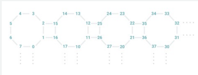
Rigetti Aspen シリーズチップ: スケーラブルな回路トポロジ。base-8でラベル付けされたグラフ構造の量子ビット間接続
